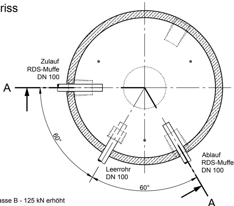
Mit Abdeckung Klasse B - 125 kN erhöht sich die Zulauf- und Ablauftiefe und die Gesamttiefe um 45 mm.
